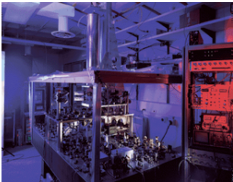
Ultrapræcis atomur: præcision 2 \times 10^{-15}
