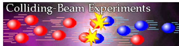
Figur 9. Princippet i et eksperiment med kolliderende stråler. Energien i centre-of-mass systemet bliver her umådeligt meget højere end hvis en enkelt stråle skydes ind i et stillestående materiale. ( Particle Data Group, LBL).
