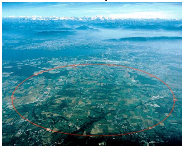
Figur 1. Beliggenheden af CERNs 27 km lange accelerator tunnel ved Geneve (CERN).
